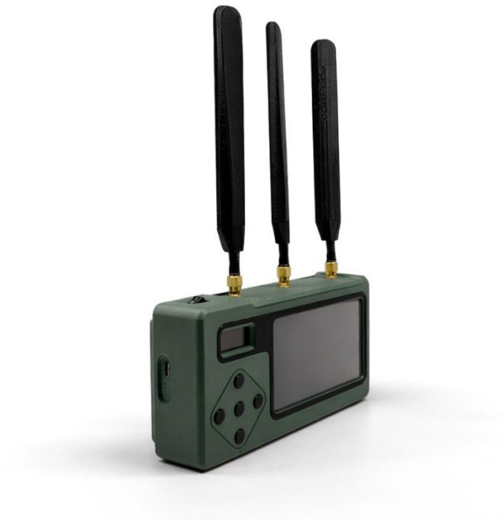
Рисунок 1.7 – Роз’єм живлення USB Type-C на корпусі пристрою
