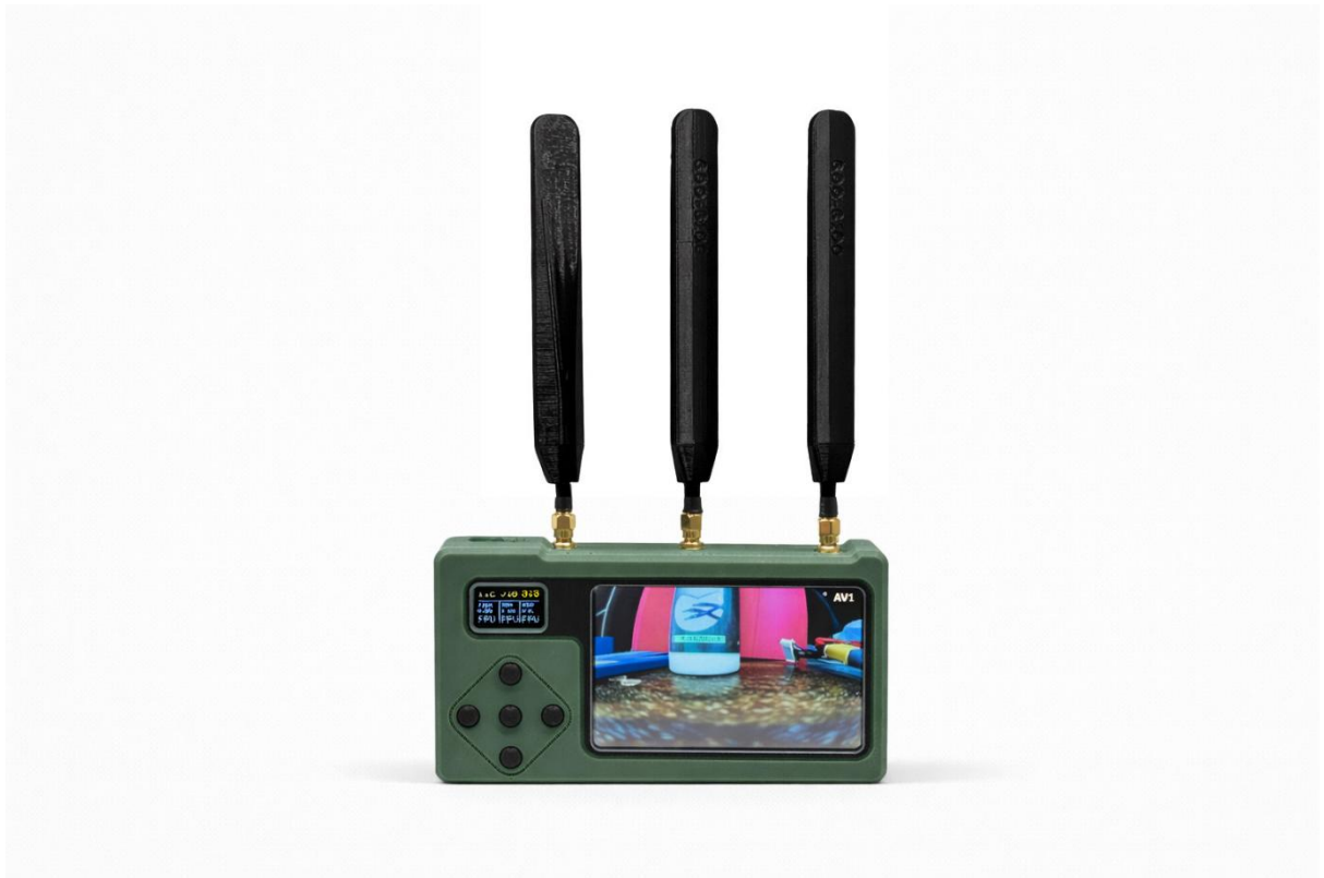
Рисунок 1.3 – Основний дисплей детектора у режимі відображення відеосигналу
