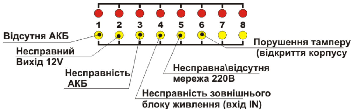
Рисунок 5.2 – Розширена індикація несправностей живлення для Тірас-8П.1
