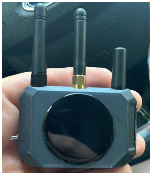
Рисунок 3 - Варіант пристрою "Тенета PRO" з трьома антенами, з можливістю виявлення 2,4ГГц
