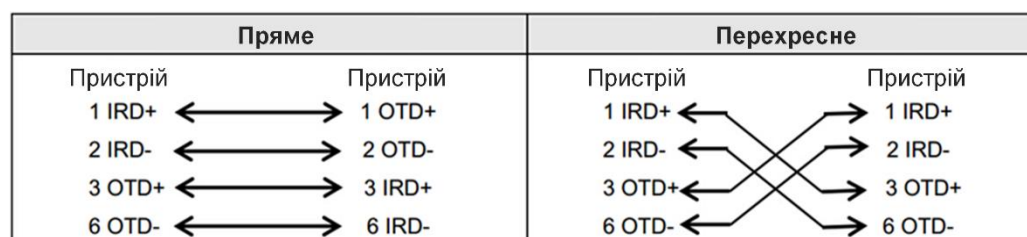
Figure 7-3 З'єднання витой пари 100BASE-TX
